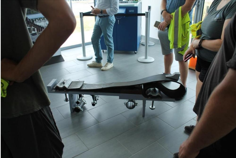
Figure 26. Principe du barrage gonflable de BAMEO
