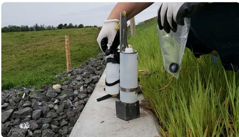
© COBARIC, 2020. Préparation des bouteilles pour l'échantillonnage d'eau.
