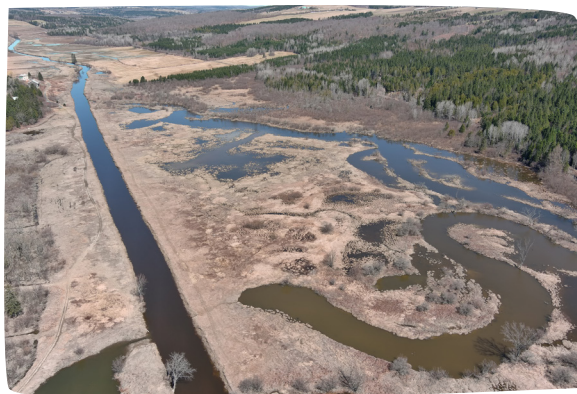
Le Bras Saint-Victor linéarisé. À droite les bras morts rendent visible l'ancien tracé. COBARIC, 2020.
